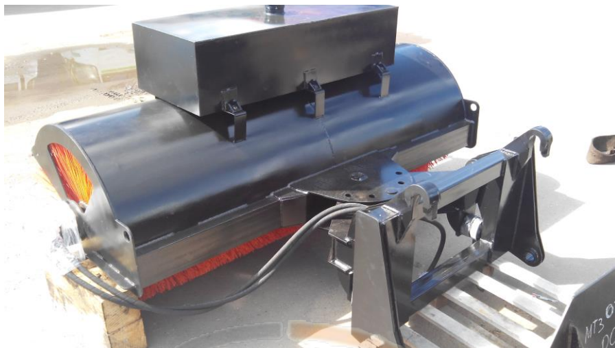
Щётка ПФ-3 в сборе (комплектация с системой орошения).
