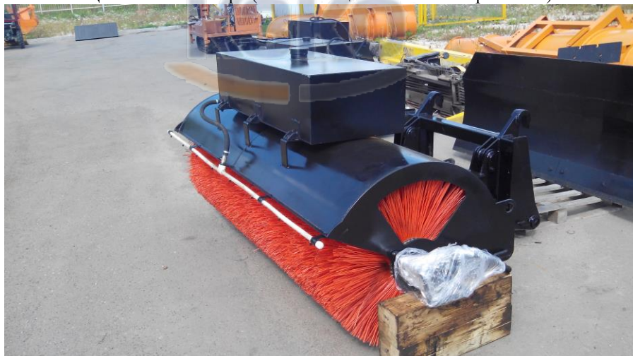
Щётка ПФ-3 в сборе (комплектация с системой орошения).
